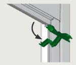
Um die Transportsicherung zu lösen, drücken Sie diese auf der hinteren Seite nach unten.
