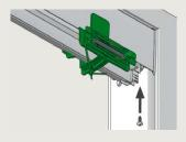
Die Kassette wird, nachdem sie auf die Träger aufgeschoben wurde (Abb. A6, B6, C6), an beiden Seiten verschraubt.
