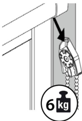
Die Kindersicherung wird ausgelöst, sobald mehr als 6 kg die Kette belasten. Sollte dies der Fall sein, können Sie das Kettengetriebe, wie in Schritt 6 gezeigt, wieder in die Kasette stecken.
