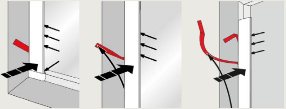
**Die Klebeverbindung erreicht die maximale Haftung nach 72 Stunden.**
