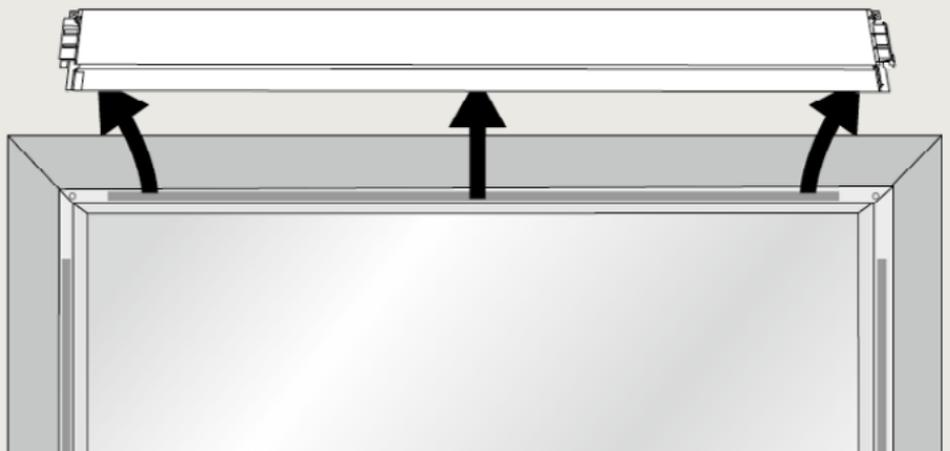
**Kleberückstände entfernen:** Man kann das verwendete Klebeband vollständig ohne Lösungsmittel wieder ablösen. Entfernen Sie Kleberückstände durch Überdehnung in Kleberichtung, nicht durch Zug in spitzem Winkel! Wärme begünstigt die Ablösung, z. B. Haartrockner.
