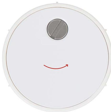
2. Drehen Sie die Sicherungsschraube mit einem Schlitzschraubendreher zwei Mal gegen den Uhrzeigersinn.
