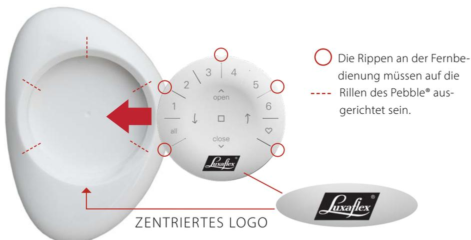
Montage des Gehäuses für die Wand:
